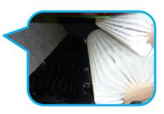
低速回転の段付ラセンブラシ と、高速回転の長毛ブラシに より、原料を踊らせながら磨 きあげます。
