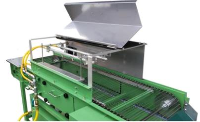
噴射ノズル調整や点検がしやすい開閉カバー
